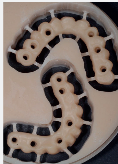
Fig. 13 Composito fresato posizionato nel disco prima della rifinitura.
