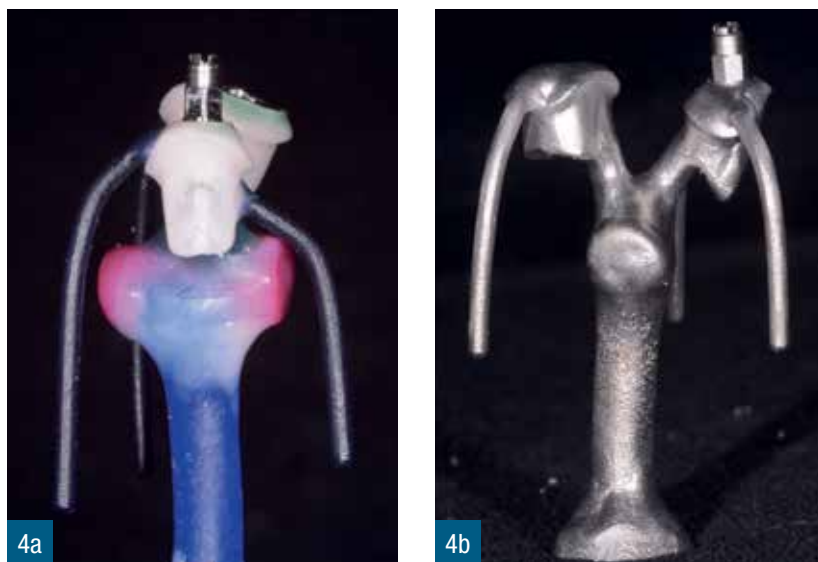
Figg. 4a,b Tecnica della fusione a cera persa con componenti calcinabili e UCLA.
