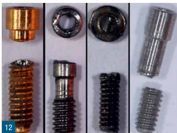
Figg. 11a-f Fabbricazione di un dispositivo su pilastri fresati e protesi cementata (tecnica e clinica). Fig. 12 Complicanze meccaniche delle viti di connessione. Fig. 13 Frattura dell'impianto.
